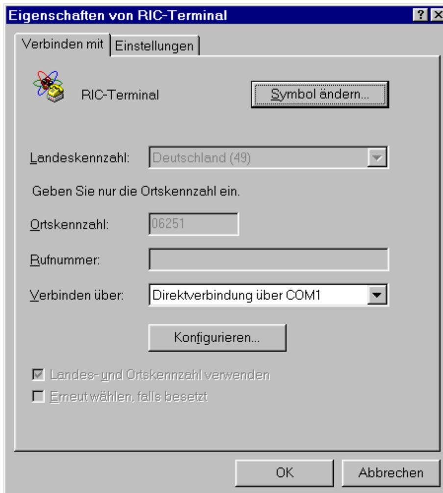
**Schritt 2:** Stellen Sie die Kommunikationsparameter ein. Das RIC kommuniziert mit 9600 Baud (Auslieferungszustand), 8 Datenbits, ohne Parity, einem Stopbit und ohne besonderem Handshake-Protokoll. . In HyperTerm finden Sie diese Einstellung im Menü <Datei><Eigenschaften> nach Drücken der Befehlstaste „Konfigurieren“:
